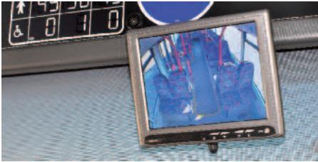
Auf einem Monitor kann der Fahrer mittels mehrerer Kameras sowohl den Fahrgastraum des Anhängers als auch die Außenbereiche zwischen Zugfahrzeug und Anhänger einsehen.
